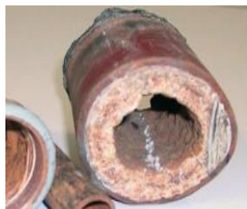
Tvrda voda predstavlja prijetnju kotlovnicama – dokazi te prijetnje obuhvaćaju značajno smanjenje toplinske učinkovitosti uređaja
